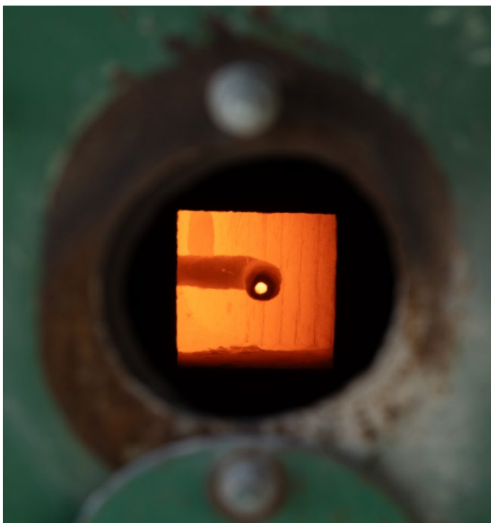
Sur la photo : combustion du gaz de pyrolyse, servant à alimenter le tambour
