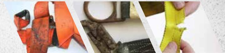
**HARNAIS, LONGES DE SÉCURITÉ ET LIGNES DE VIE AUTORÉTRACTABLES** - usure; saleté; brûlures; boucles et attaches endommagées; anneaux déformés; indicateur de chute déployé; mécanismes de freinage défectueux; amortisseurs déployés; coutures manquantes; boîtier fissuré; câble rouillé.
