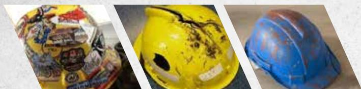
**CASQUE DE PROTECTION** – fissures; décoloration; un trop grand nombre d'autocollants, ce qui cause une détérioration; plus de 10 ans après la date de fabrication; pièces manquantes; il a subi un impact.
