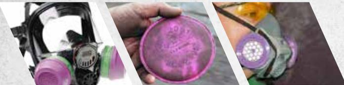
**RESPIRATEURS ET FILTRES** - dommages aux sangles, rayures, éraflures, usure excessive, ajustement correct, soupapes et joints, saleté, débris, propreté des filtres.
